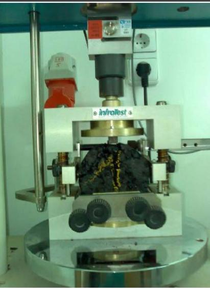
Prikaz aparature za njegovanje asfaltnih uzoraka pod vodom i aparature za određivanje vlačne čvrstoće neizravnom metodom
